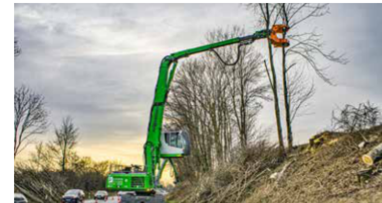
C250 en una Sennebogen para el mantenimiento de márgenes de carreteras.
