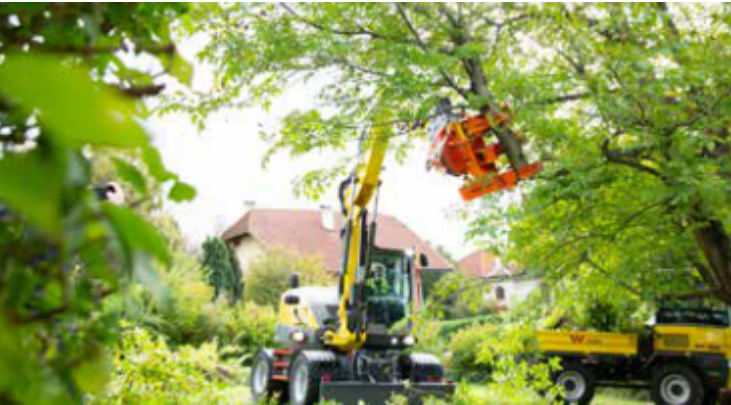
C250 en la excavadora de ruedas.
