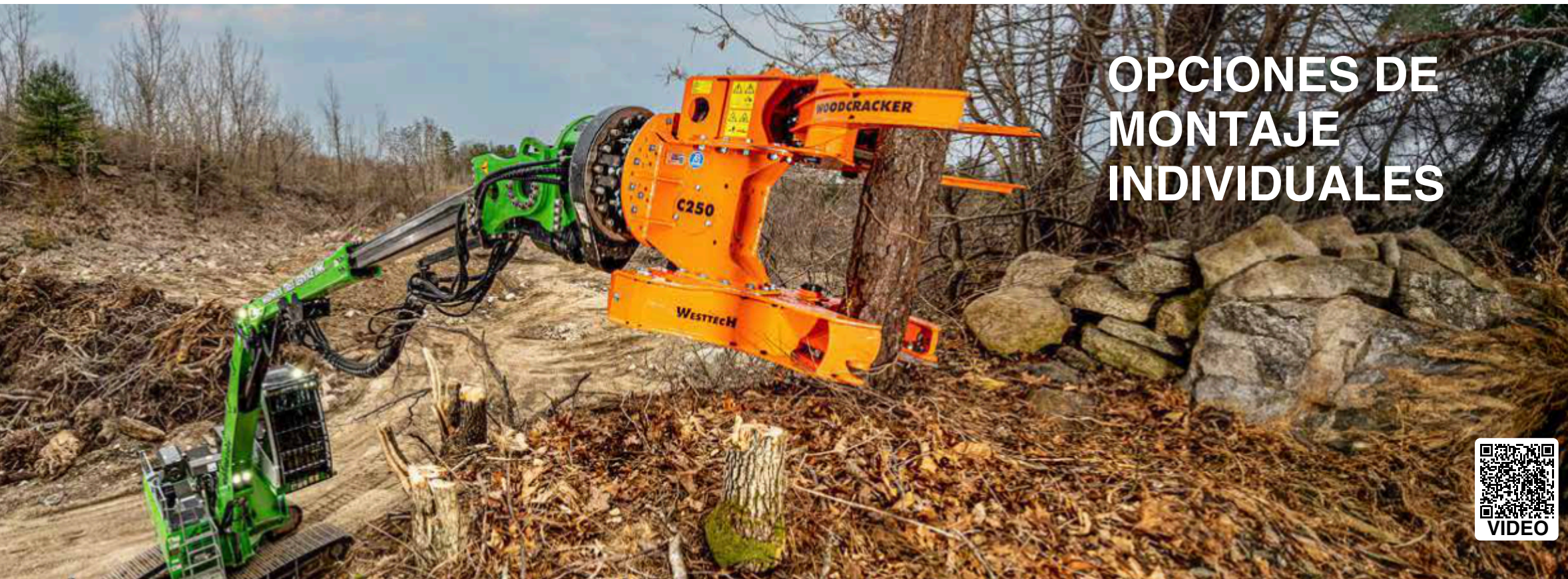
C250 en una Sennebogen para el mantenimiento de márgenes de carreteras.
