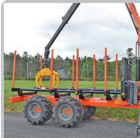
4 puentes de carga atornillados de dos posiciones (sólo chasis Pirineos). 4 bolted loading bunks with two positions (Pirineos chassis only).
