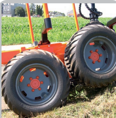
Tracción a las 4 ruedas con eje oscilante y frenos de disco a las 4 ruedas. Four-wheel drive with bogie and disc brakes at all wheels.
