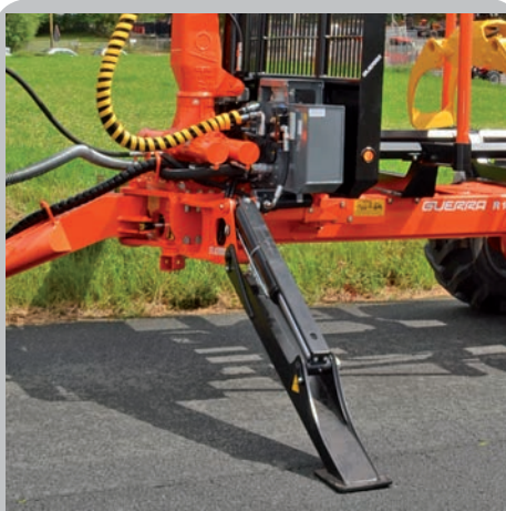
Estabilizadores abatibles y depósito de aceite (sólo en remolques con grúa). Folding stabilizers and oil tank (only on trailers with crane).
