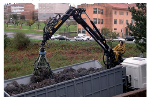
Grúa de reciclaje Recycling crane
