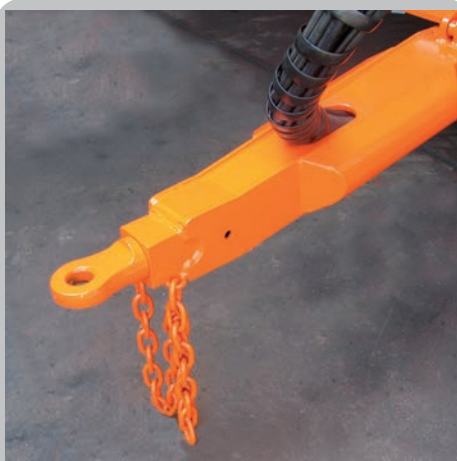
Enganche de remolque según norma ISO 21244. Trailer coupling according to Standard ISO 21244.
