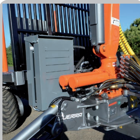
Depósito y enfriador protegido (sólo en remolques con grúa). Oil tank and cooler with protection guard (only on trailers with crane).
