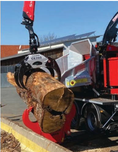
Rajadora de madera Nuestras máquinas se pueden equipar con mordazas divisorias y cuñas de hendido para permitirle procesar troncos de grandes dimensiones de forma económica.
