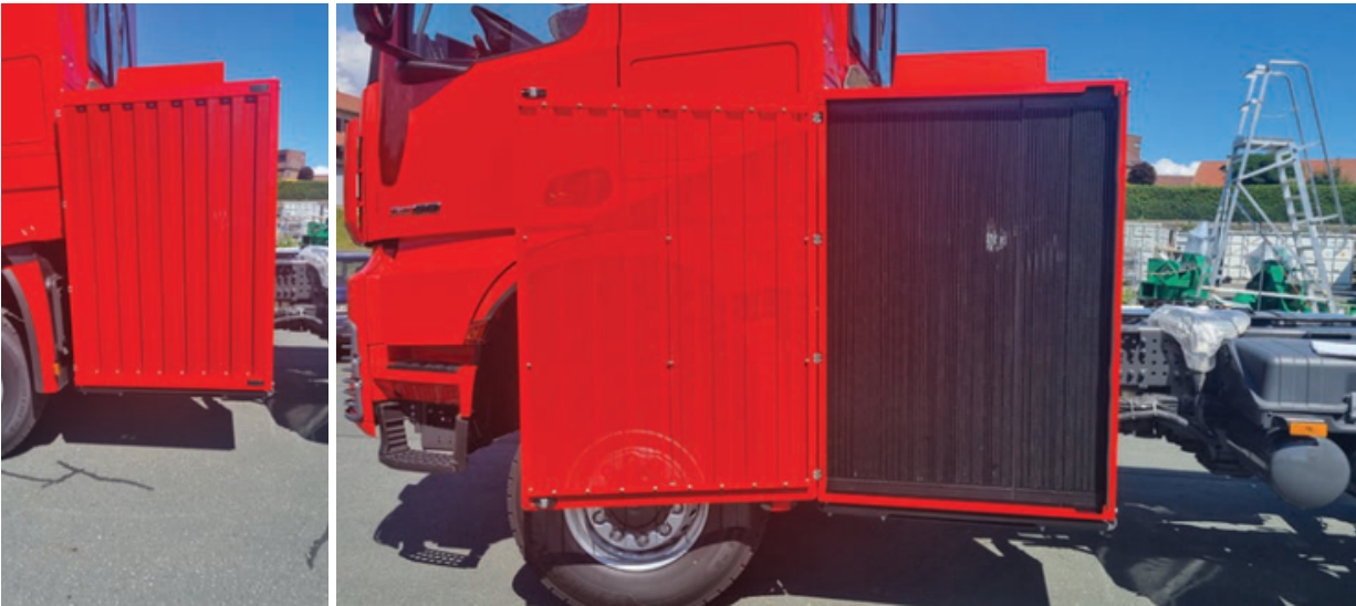
Puerta del radiador de fácil apertura para una limpieza rápida
