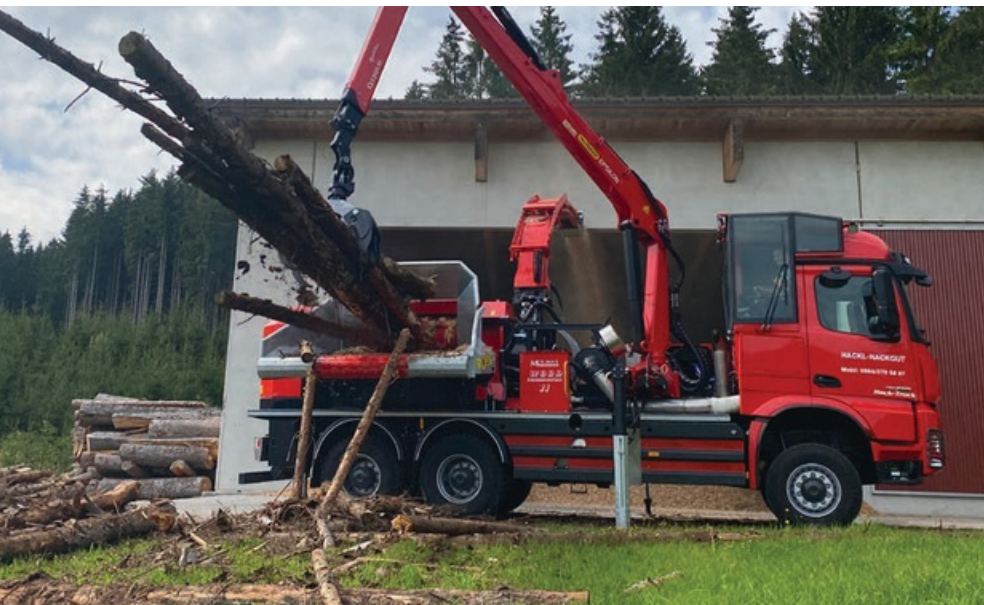
Sistema de alimentación en el modelo WT 11 NMV
