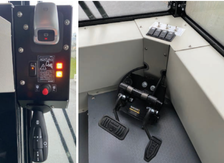
Unidad de conducción con pedales en el asiento del operador.
