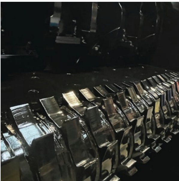
Rodillo de alimentación inferior con geometría de dientes óptima
