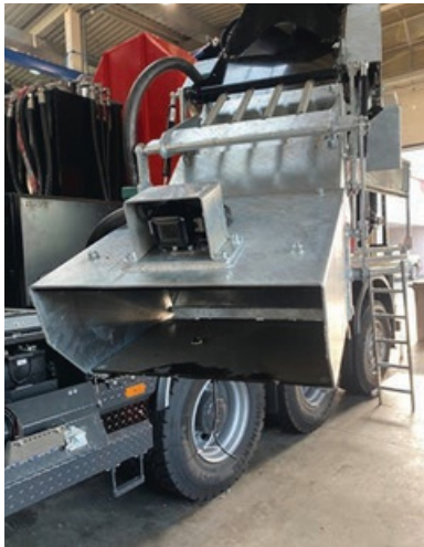
Cámara Sistema de cámaras con hasta 3 cámaras (cámara de marcha atrás, canal de expulsión, etc.).
