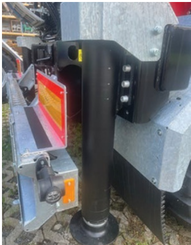
Estabilizadores Apoyo hidráulico en la parte trasera.
