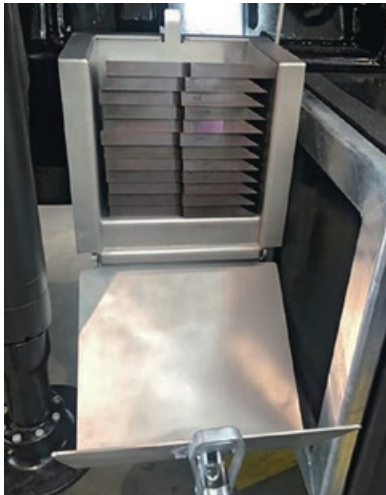
Caja de almacenamiento de cuchillas Para el almacenamiento seguro de 1 o 2 juegos de cuchillas.
