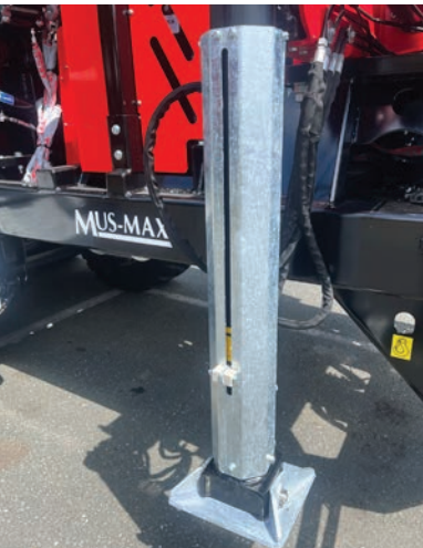
Protección para estabilizadores Cubierta robusta para el apoyo de la grúa con placa de suelo reforzada.
