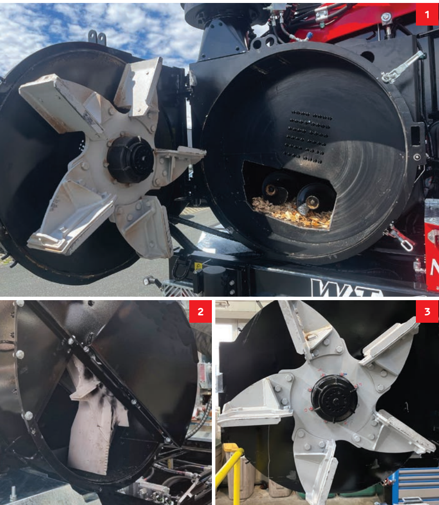
1. Soplador hidráulico con cubierta giratoria 2. Soplador mecánico con rueda libre industrial 3. Nueva pala de ventilador de alto rendimiento MUS-MAX
