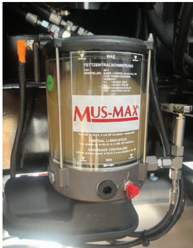
Lubricación centralizada Sistema de lubricación centralizada por grasa para la astilladora y la grúa.
