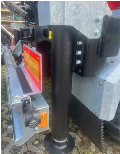
Estabilizadores Apoyo hidráulico en la parte trasera.
