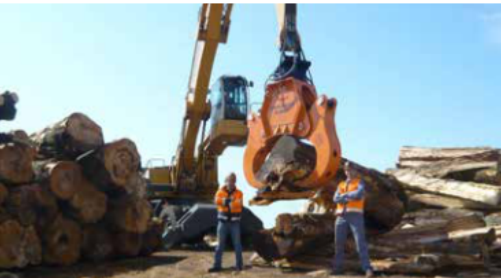
Le chariot élévateur LH 944 en fonctionnement avec le W1800.
