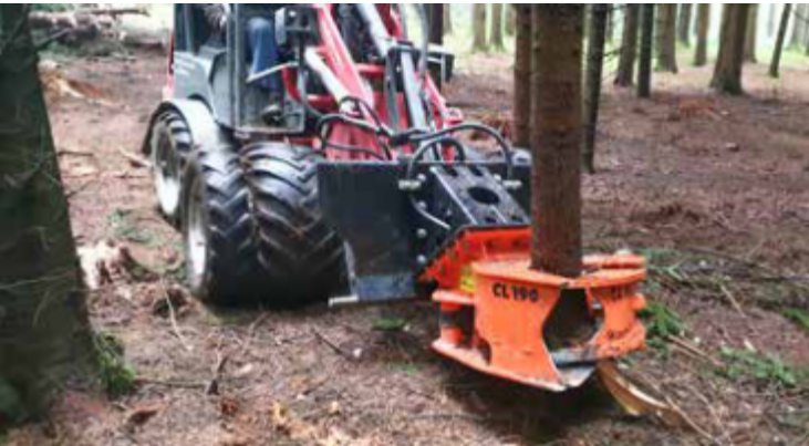
Woodcracker ® La CL190 coupe le bois tendre jusqu'à 25 cm.
