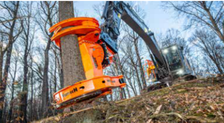
C650 con diámetro de corte de hasta 70 cm.
