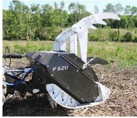
**Contracuchillas:** Las contracuchillas de la trituradora forestal F520 están diseñadas para durar, con una construcción reforzada en acero mojado. Su
